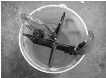
(a)钢筋网架与GFRP圆筒
